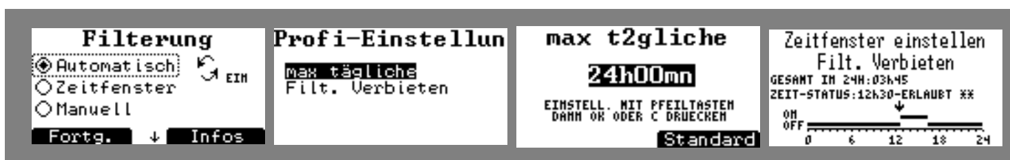
Figure 4. Programmierbildschirm der Filterung in gesteuerten Modus.
