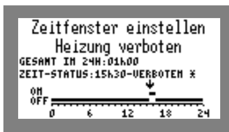
Figure 9. Konfiguration Heizung sperren
